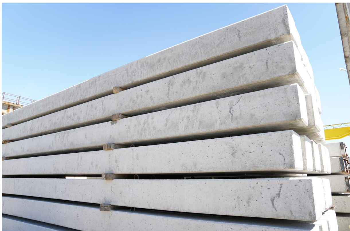
Rysunek 4.1: Centrum Pali Sp. z o. o. - prefabrykowane pale żelbetowe
